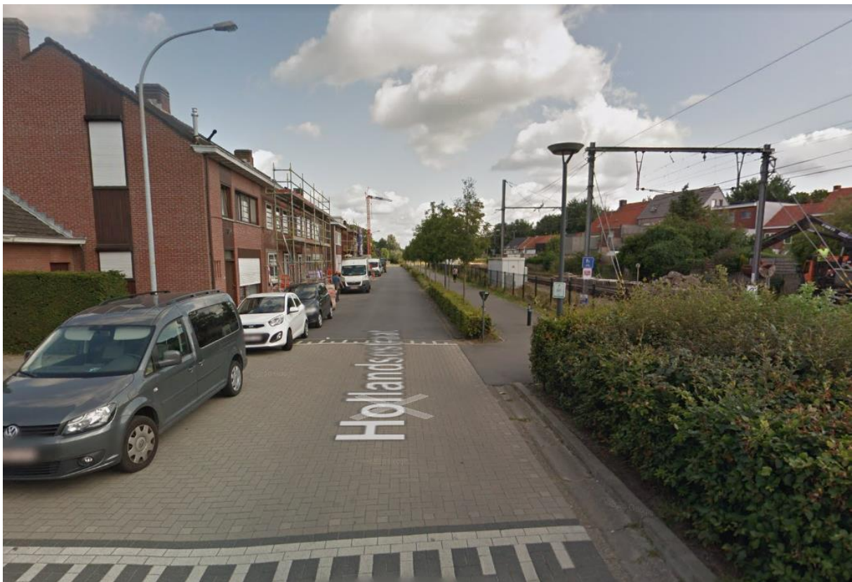
FIG 208 Kruispunt Hollandsestraat met aan oostelijke zijde ter hoogte van een verkeersplateau aansluiting met de F102 'het Bels Lijntje', een vrijliggend dubbelrichtingsfietspad. Kijkrichting noord (bron: google maps)
