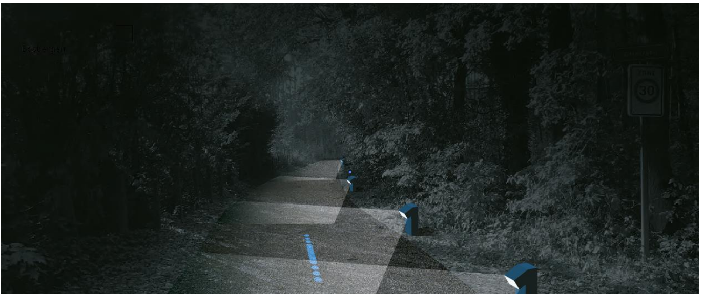
FIG 234 Simulatiebeeld huidig onverhard deel Bosbergen (segment 6): halfverharding en signalisatie met geactiveerde lage verlichting 's nachts
