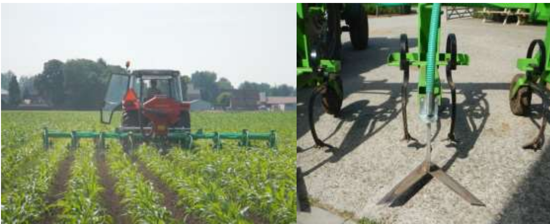
Figuur 1: Schoffelmachine met pneumatisch zaaimachine
