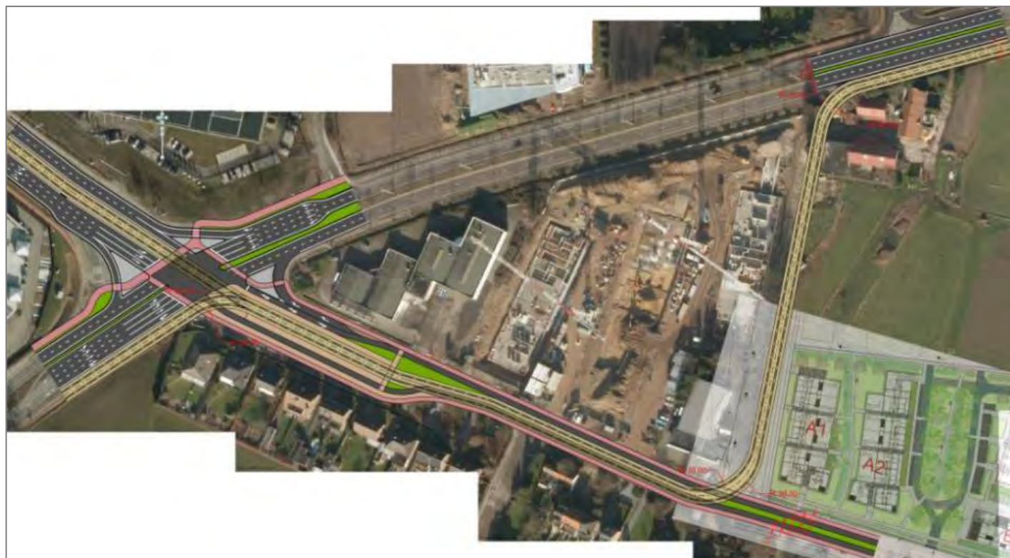
Schetsontwerp voor de inrichting van knooppunt Houtlaan-Merksemsebaan. Bron: studie ontwerp onderzoek voor tramtracés op de Houtlaanbrug te Wijnegem.
