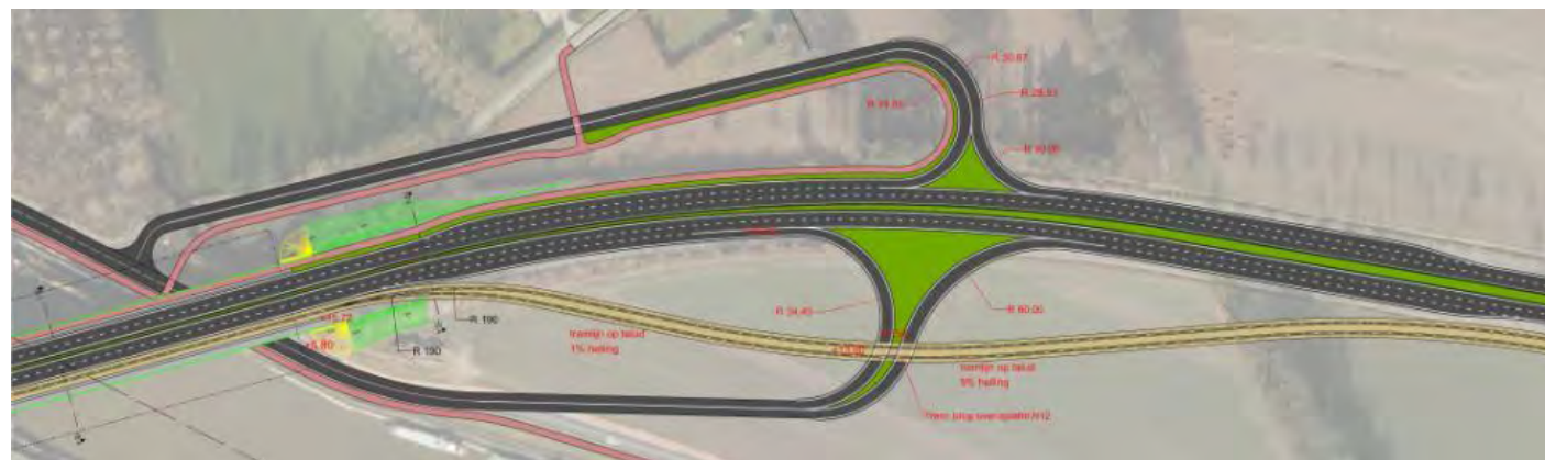
Schetsontwerp sneltramtracé op bestaande Houtlaanbrug, met ongelijkgrondse aantakking op Metropoolstraat naast het Albertkanaal.
