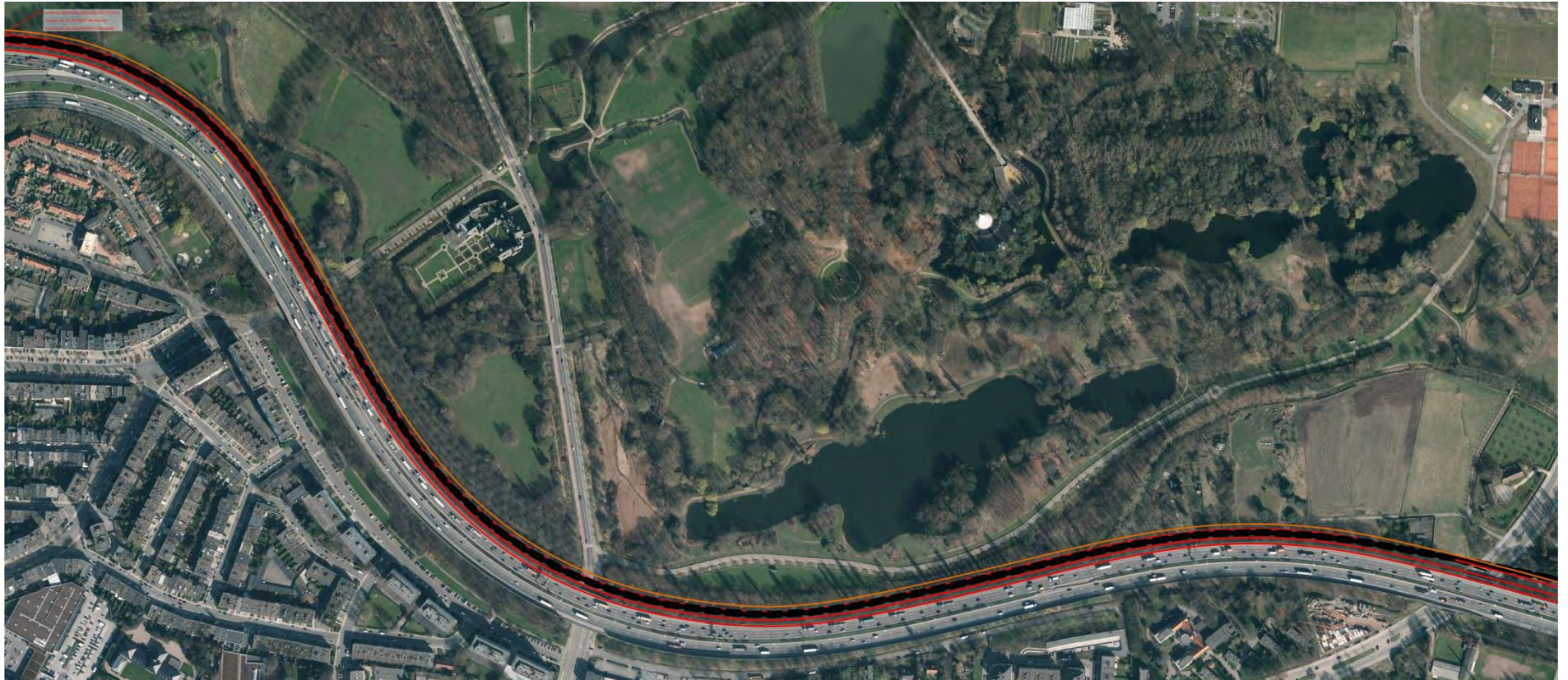
Tracéstudie E313 ter hoogte van Rivierenhof: in blauw aanleg tramantenne naar P&R Wommelgem. Rode lijn = ruimte-inname door verbreding E313 en tramtracé, oranje lijn: rand van het noodzakelijke talud (tussen oranje lijn en E313 moet ontbost worden).
