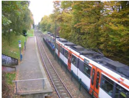
Bielefeld met dubbel tramstel (54 m x 2,30 cm) op geheel vrije baan op meterspoor (links) en Schaarbeek, Koninginnelaan met bijzondere overrijdbare bedding met tramstel (2,30 x 43,3 m) op normaalspoor (1,435 m)
