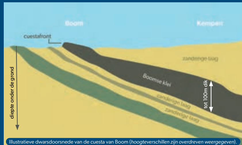
Illustratieve dwarsdoorsnede van de cuesta van Boom (hoogteverschillen zijn overdreven weergegeven).
