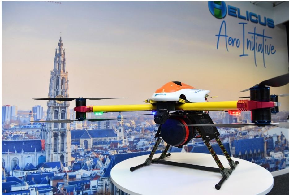
Als het echt misloopt en alle motoren uitvallen, opent de 25 kilo zware drone een parachute en gaat een sirene loeien. © Jan Van der Perre
