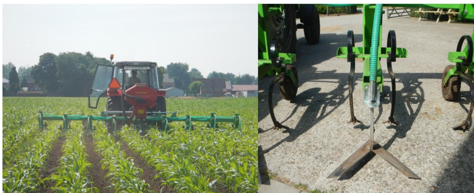
Figuur 13: Schoffelmachine met pneumatische zaaimachine
