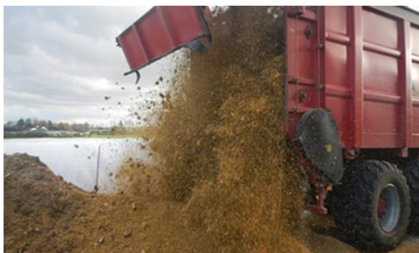
Fig.7: Loswagen met verdeelwalsen voor het mengen van de voederbieten met de mengpartner.
