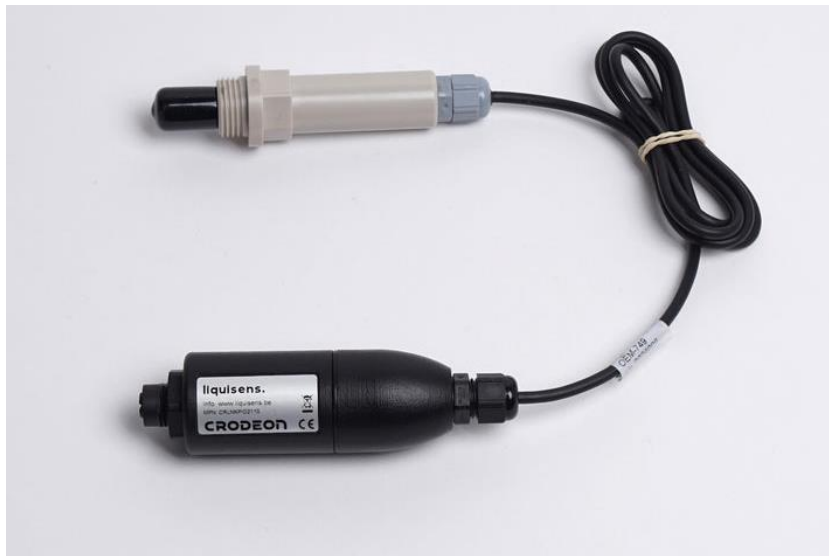
Figuur 12. Probe die pH, ORP, EC en temperatuur meet. Deze sensor kan je aansluiten op een reporter om realtime data op te volgen.
