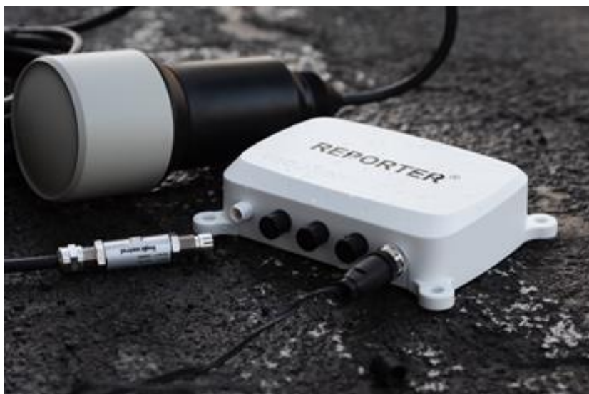
Figuur 10. Draadloze sensormodule met een Reporter van Crodeon Technologies.
