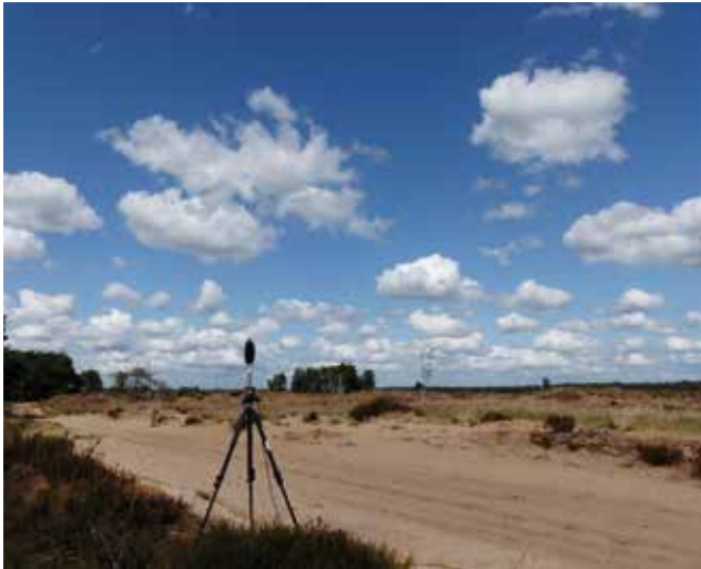
Figuur 2a: Geluidsmeeettoestel van het PIH opgesteld in de Kalmthoutse Heide © Provincie Antwerpen, Willy Verbruggen
