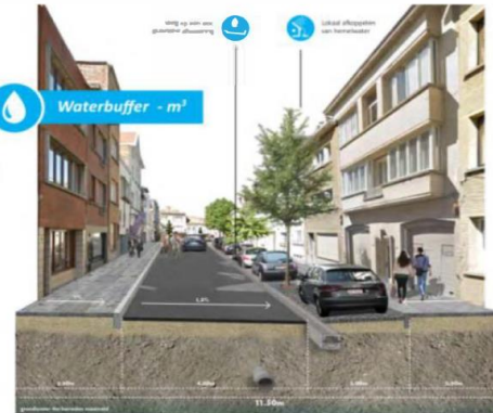
Uitgewerkte impressie technisch watertransporterende straat
