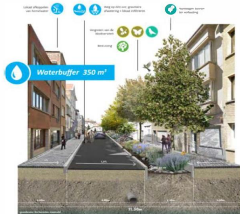
Uitgewerkte impressie Bioswale / groene watertransporterende straat
