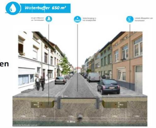
Uitgewerkte impressie technisch waterbergende straat
