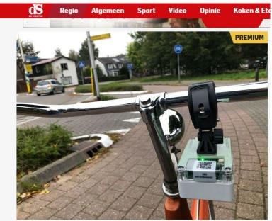
Snuffelfiets wordt in Zwolle geïntroduceerd. De sensoren meten fijnstof, maar ook snelheid en bijvoorbeeld opstopping in het verkeer. © Snuffelfiets/Civity
