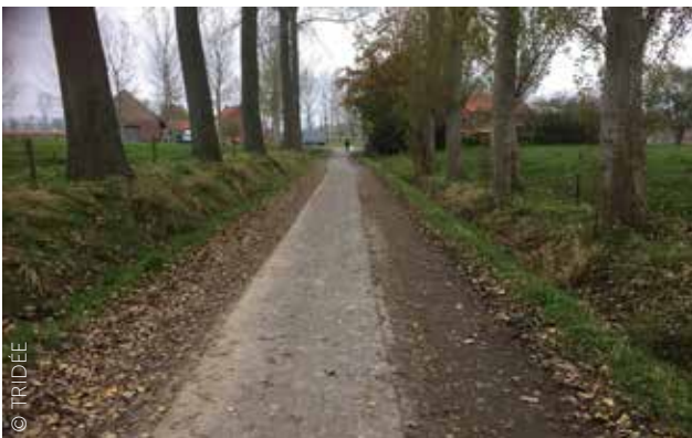
Links: Zwijndrecht. Smalle rijloper van asfalt en stevige onverharde randen. De weg straalt duidelijk uit dat hij niet is bedoeld voor doorgaand gemotoriseerd verkeer. Fietsers kunnen veilig uitwijken. Voor gemotoriseerd verkeer zijn er uitwijkmogelijkheden bij zijwegen of toegangen tot percelen. Rechts: Huldenberg. Door de betonnen sporen kunnen fietsers en voetgangers relatief comfortabel gebruik maken van de onverharde landbouwweg. Dit profiel is niet geschikt voor intensief gebruik door autoverkeer of fietsers.
