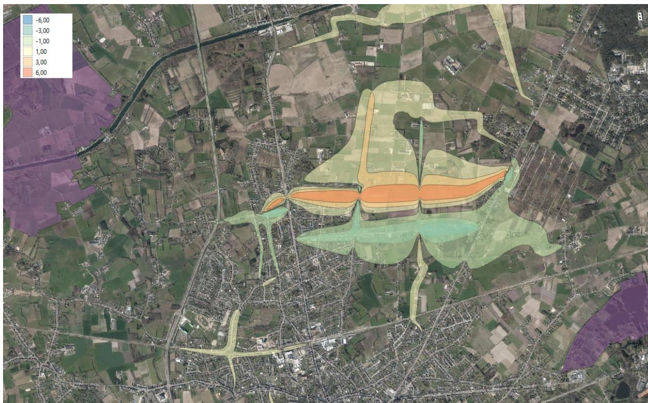
Figuur 12-26: Resultaten verschilkaart geluidsmodellering voor alternatief G1-primair in combinatie met de ligging van de Habitatrichtlijngebieden.
